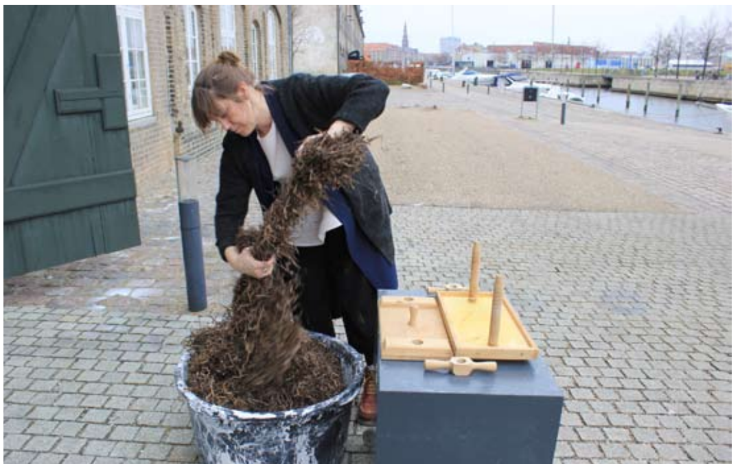
Fotos: Et afgangsprojekt fra arkitektskolen i København beskriver en helt ny type tag, nemlig et kombineret strå- og tangtag. Dvs. at der først tækkes med tagrør eller tækkemiscanthus (en speciel type elefantgræs) og oven på stråtaget lægges et lag ålegræs. Inspirationen til det er hentet fra Kina. Den ene af de to afgangsstuderende, Lise Hornehøj Garval, er på billedet herunder i gang med at lave mockup'en med det kombinerede strå- og ålegræstag. (fotos: Nanna Hedensted Lundorf)
