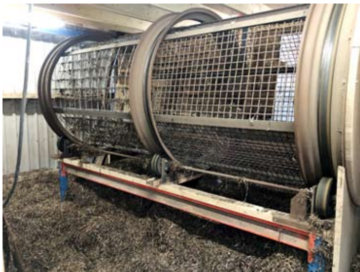
Foto: Tromle til sortering af ålegræs.
