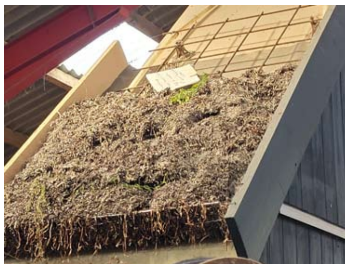
Foto th: Tag under opbygning på fuldskala test model, hvor ålegræs er toplan. Herunder slanger til køl og varme (dog her uden det tiltænkte lerlag, som er vist på diagrammet øverst på denne side).
