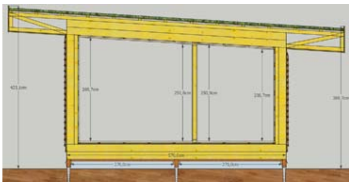
Fotos: På snittet til højre ses at huset hviler på fundaments-skruer. På billedet herunder bores fundamentsskrue i jorden. Herover ses fundaments-trærammen med afdækning mod jord.
